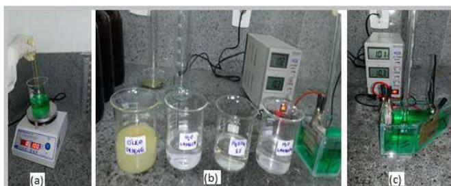
**Figura 1:** Sistema de Niquelagem de Latão. (a) aquecimento do banho; (b) pré-tratamento do painel de latão; (c) eletrólise em meio aquoso. Fonte: Própria.
